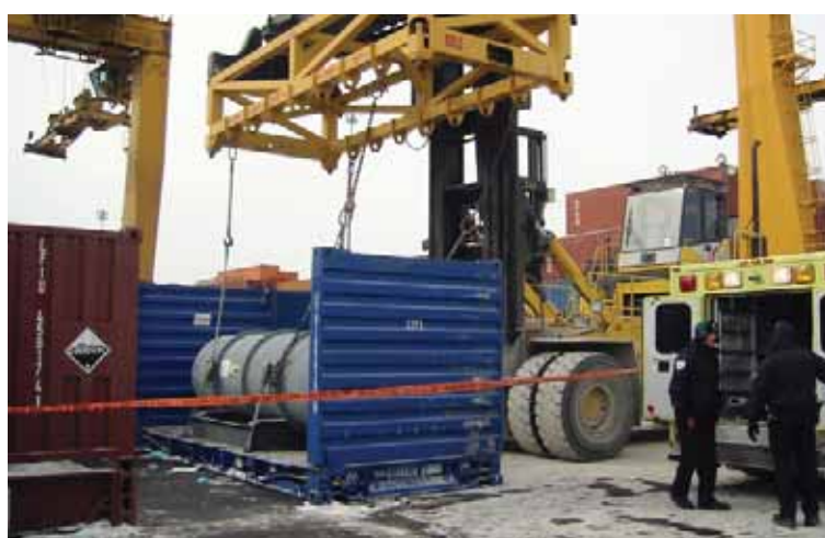
Un cylindre contenant de l'uranium s'est déplacé de son ancrage.
