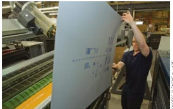
Le processus comporte plusieurs étapes : du montage (préresse), au coupage et au pliage. À partir des fichiers numériques, ils installent le matériel à imprimer sur des plaques d'aluminium. Les plaques sont ensuite installées manuellement dans la presse pour chacune des quatre couleurs primaires nécessaires au procédé. Les feuilles sont imprimées recto verso avant d'être coupées et pliées.
